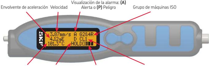
Temperatura Estado de la medición Indicador de batería (60% llena) Clase de envolvente de aceleración
